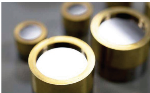
Примарни српски еталони звучног притиска (гарнитура 4180, гарнитура 4160) Primary Serbian sound pressure measurement standards (4180 set, 4160 set)
