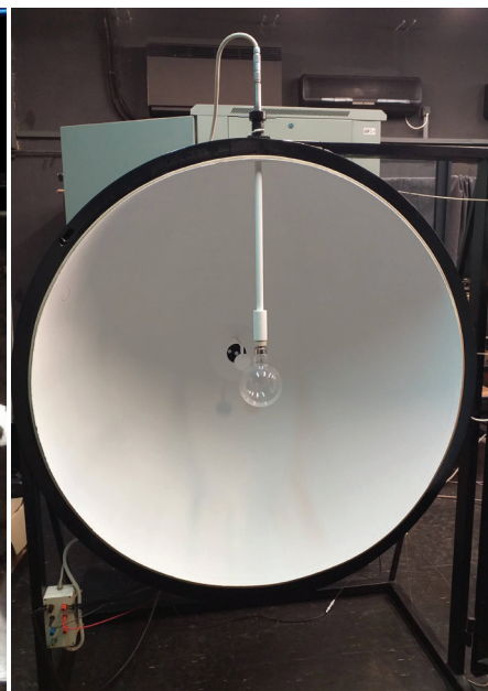
Мерење свјетлосног флука у интеграционој сфери
