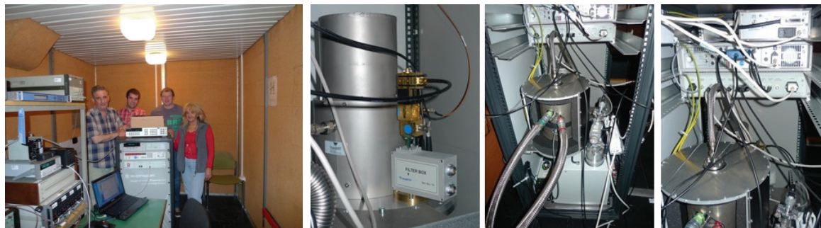
Поређење националног еталона једносмерног електричног напона на бази Цозефсоновог ефекта са еталоном VIPM – VIPM.EM-K10.b
