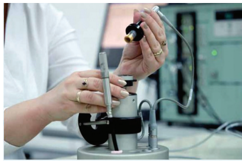
Примарна реципрочна метода еталонирања на притисак лабораторијских еталон микрофона тип LS1P и LS2P по стандарду IEC 61094-2 Primary pressure reciprocity calibration method of laboratory standard
